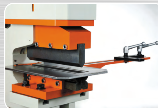
*優力膠剝料器 (展示用，已拆除安全護蓋)
