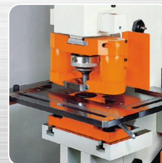
*優力膠剝料器 (展示用，已拆除安全護蓋)
