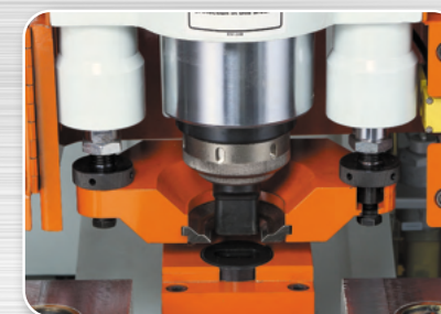
油壓剝料器為全自動定位桌之標準配件， 使材料之變形量減至最小
