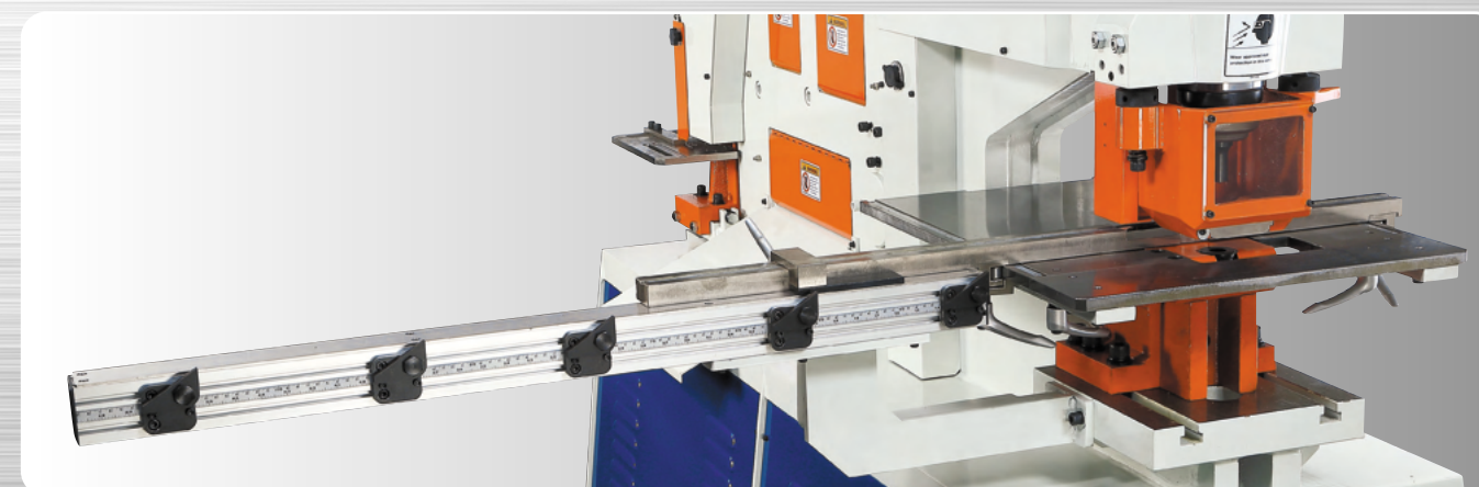
*多點式定工作台(限用於S/SD/KD及PM機型)
