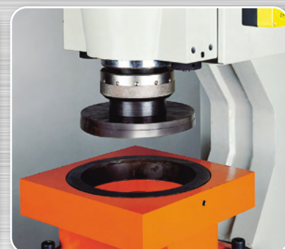
*大孔徑之沖孔 (展示用，已拆除安全護蓋)
