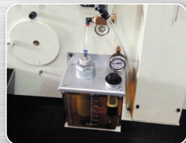
*自動噴油系統可大幅增加模具之壽命
