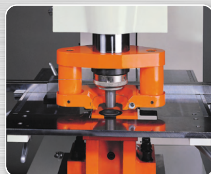
*優力膠式的剝料器，可降低沖孔時的變形 (展示用，已拆除安全護蓋)
